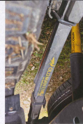
Das Old Man EMU Fahrwerk erspäht man nur bei genauer Betrachtung. Höher ist der Mitsubishi L200 geworden, mehr Federweg verhilft ihm zu mehr Bodenfreiheit und Verschränkung. Der Dachträger gehört eher zur robusten Gattung
