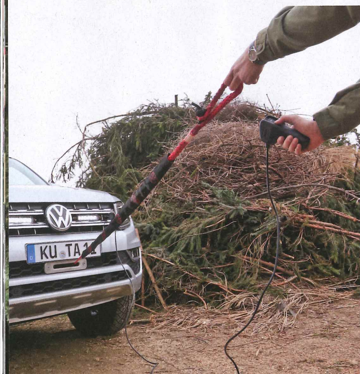
Die beim Amarok in die Frontstoßstange integrierte Seilwinde ist schön dezent und mit Kunststoffseil bestückt. Der Softschäkel kann gut in der Aluabdeckung verkeilt werden
