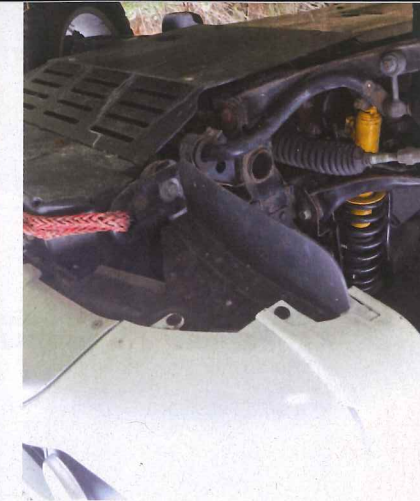
Das Old Man EMU Fahrwerk erspäht man nur bei genauer Betrachtung. Höher ist der Mitsubishi L200 geworden, mehr Federweg verhilft ihm zu mehr Bodenfreiheit und Verschränkung. Der Dachträger gehört eher zur robusten Gattung
