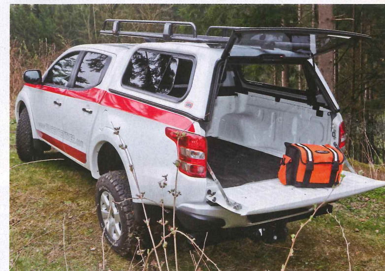
Das Old Man EMU Fahrwerk erspäht man nur bei genauer Betrachtung. Höher ist der Mitsubishi L200 geworden, mehr Federweg verhilft ihm zu mehr Bodenfreiheit und Verschränkung. Der Dachträger gehört eher zur robusten Gattung
