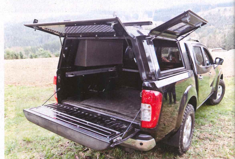
Das Hardtop ist mit zwei seitlichen Klappen ausgestattet, eine ist zum Werkzeug-/Zubehörfach ausgebaut und das andere ermöglicht den Zugriff zum Laderaum
